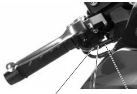
Controdado (3) Vite di regolazione (2) Manicotto in gomma (1)
